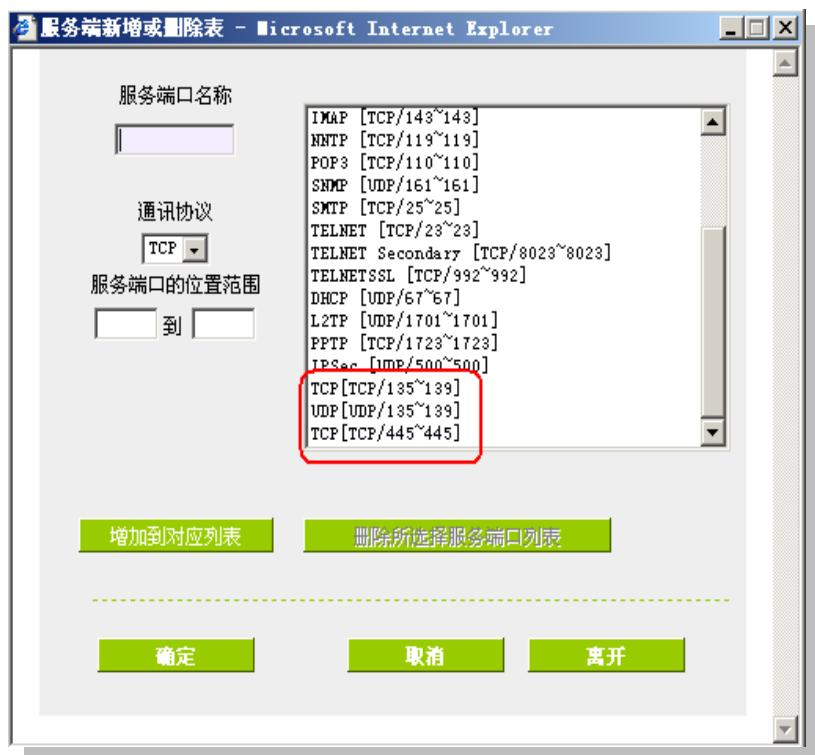
b.用防火墙里面的“存取规则”功能将设定好的此三组端口封锁：
