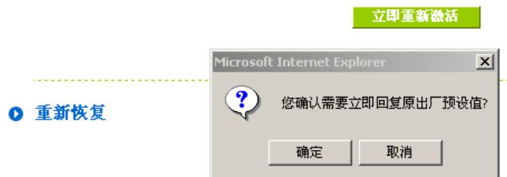
我们建议在做版本升级前请先将路由器现在的设定值存在计算机，等做完版本升级后，使用此功能将机器做出厂值设定以确保机器升级后的稳定性，然后再将刚才存在计算机的设定直存回路由器(如何存储路由器的设定数据及升级完成后如何存回路由器，请参考 12.3 系统设定参数存储说明)。
