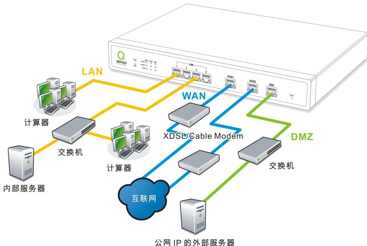
**广域网络联机:** WAN 端口可以连接如 xDSL Modem 等接入互联网。
