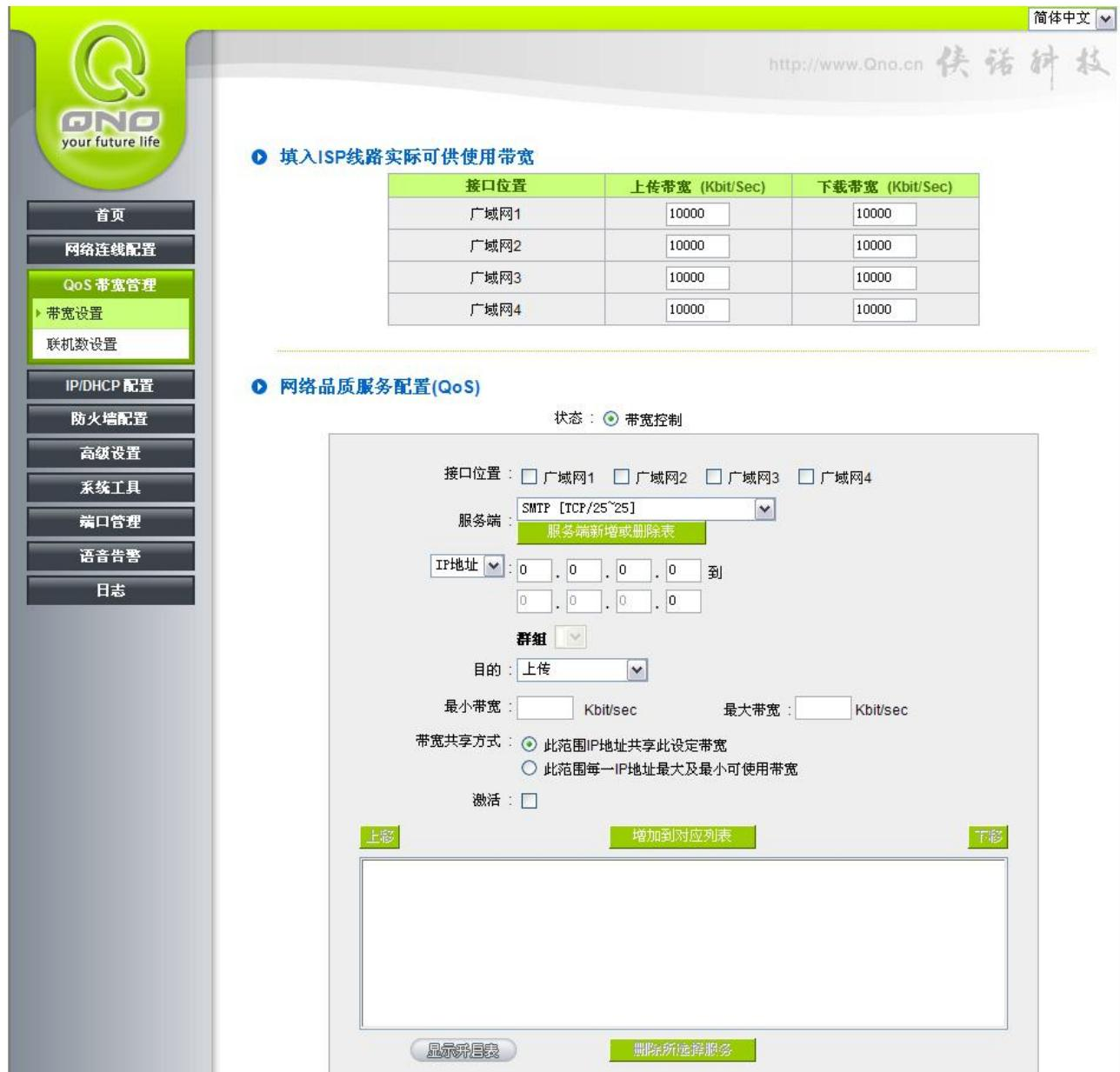
The screenshot shows the QNO router's QoS configuration page. The left sidebar menu includes: 首页, 网络连接配置, QoS 带宽管理 (highlighted), 带宽设置 (selected), 联机数设置, IP/DHCP 配置, 防火墙配置, 高级设置, 系统工具, 端口管理, 语音告警, and 日志.
