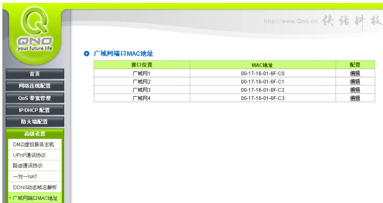
选择您要配置的广域网端口, 比如“广域网 1”, 点击“编辑”进入广域网 1 的端口 MAC 地址配置窗口, 使用者可以自行输入提供给 ISP 的网卡物理地址 MAC, 点击此按钮“确认”即会存储刚才所变动的修改设定内容参数, 点击此按钮“取消”即会清除刚才所变动的修改设定内容参数, 此操作必须于确认存储动作之前才会有效。
