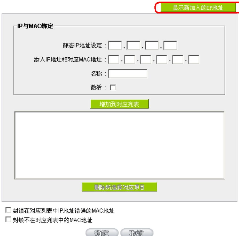
点击之后会弹出 IP 与 MAC 绑定列表对话框，此对话框里会显示网内未做绑定的 pc 的 IP 与 MAC 地址对应情况，输入计算机“名称”和“激活”上“√”选，再在右上角点确定。
