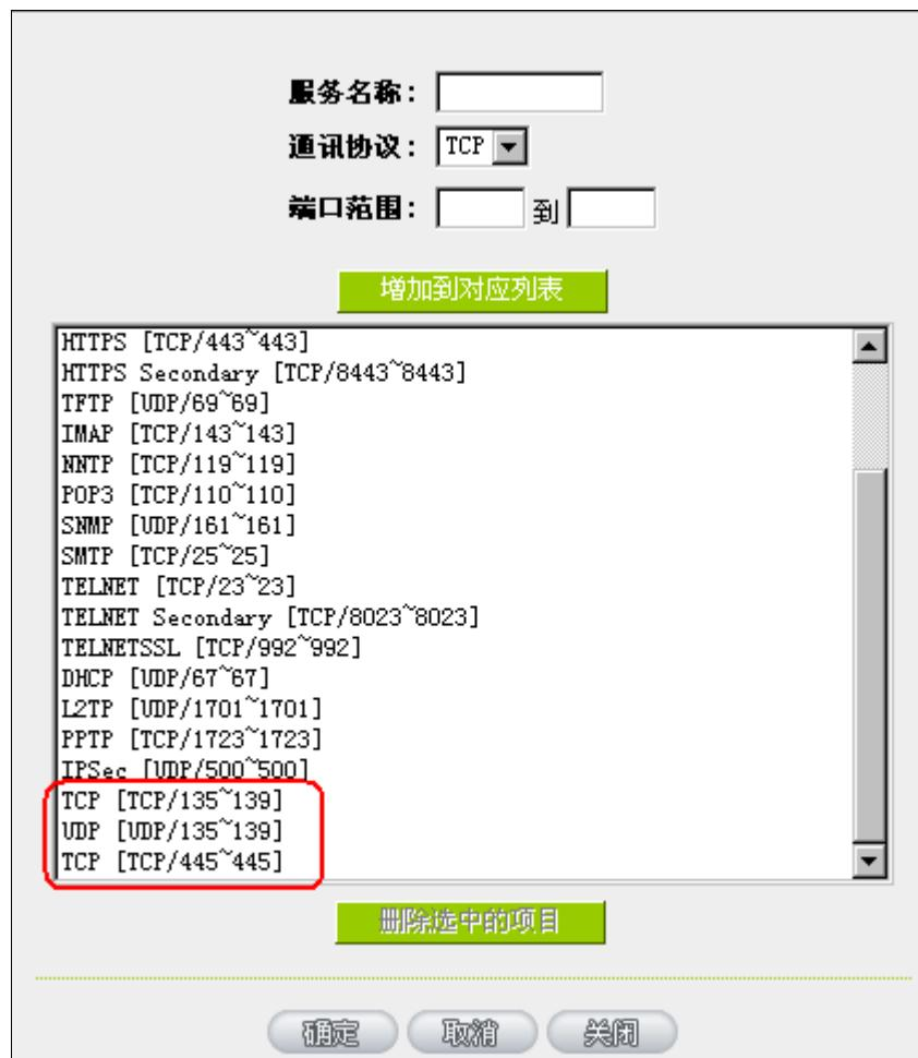
b.用防火墙里面的“存取规则”功能将设置好的此三组端口封锁:
