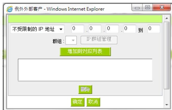
不受 Inbound L7 Filter 管制的外部用户。例如某企业北京总公司的 ERP 服务器，除了北京总公司内部员工之外、只有天津、石家庄两个分公司在使用。则可将天津、石家庄两个分公司的 IP 范围加到例外外部客户，当系统辨识到进入的流量是来自天津、石家庄两个分公司时，则会直接允许通过，不会再进入 Filter 流程中，以加快服务速度。
