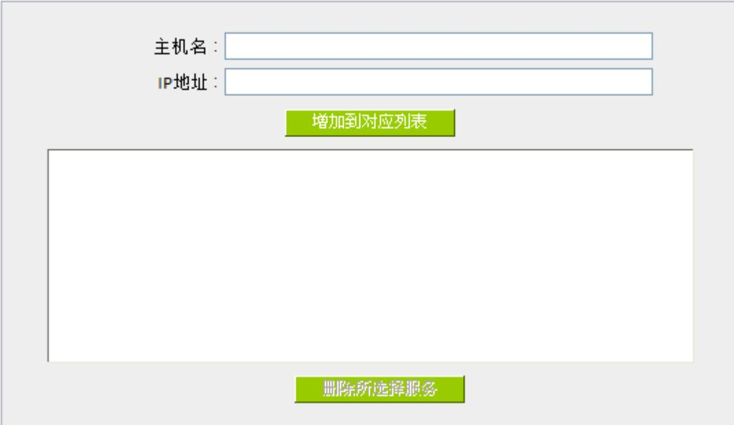
※请注意：使用 DNS Local Database 功能时需要将 DHCP 服务器的 DNS 网络服务设定为路由器的 IP 地址。设定方式请参考第 62 页的内容。
